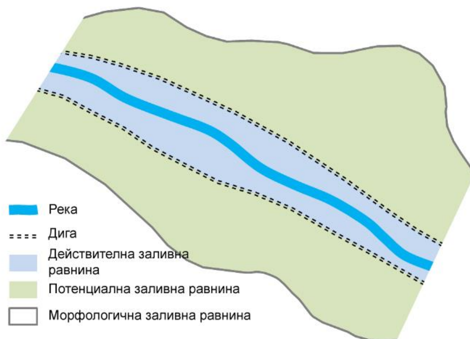
Фигура 3: Схематично представяне на действителната (активна) заливна равнина, морфологичната заливна равнина и потенциалната заливна равнина
