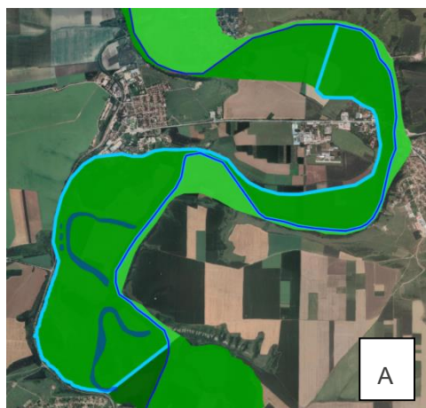
Фигура 10: Участък на заливна равнина (маркиран в ярко синьо) с висок потенциал за намаляване на риска от наводнения, по-специално за подробен параметър „Характеристики на заливната равнина (А.5)“ (А) в сравнение с предишното изправено речно корито с откъснати меандри на р. Янтра (В, взето от INTERREG (INTERREG – DANUBE TRANSNATIONAL PROGRAMME 2020))
