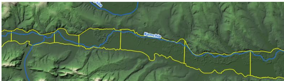
Фигура 4: Сегментирана морфологична заливна равнина на долната част на р. Камчия, разделна на участъци с дължина 10 km (някои участъци са с дължина под 10 km поради допълнителната сегментация в началото и в края на РЗПРН и остатъка от реката над речното устие)
