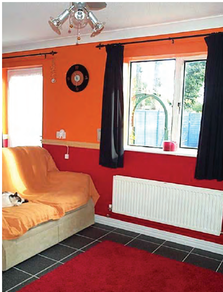
Дом с устойчиви на наводнения под и стени, повдигнати електрически уреди и подвижни мебели
